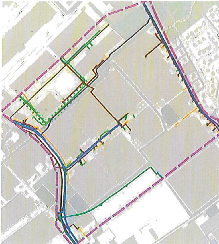
Figuur 18: Bestaande kabels en leidingen (KLIC Viewer)
