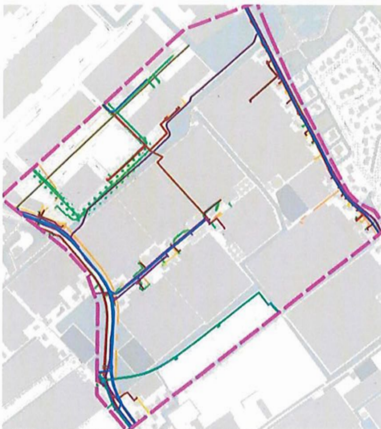
Figuur 18: Bestaande kabels en leidingen (KLIC Viewer)
