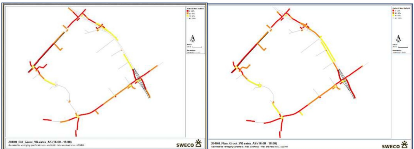
Fig. 5. Verkeersafwikkeling in de avondspits 2040 zonder (links) en met (rechts) uitbreiding van ABC Westland
