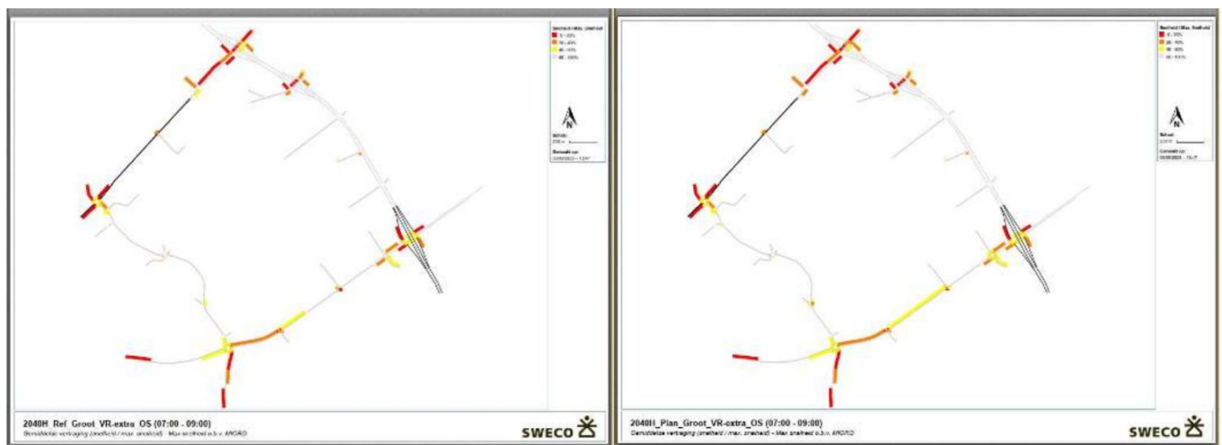
Fig. 4. Verkeersafwikkeling in de ochtendspits 2040 zonder (links) en met (rechts) uitbreiding van ABC Westland
