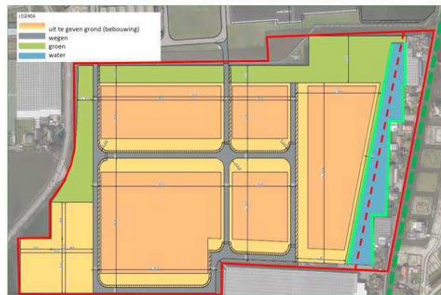
Schets van het nieuw aan te leggen bedrijventerrein ten opzichte van het NNN (groene stippellijn aan oostzijde). De rode stippellijn geeft de circa 50 meter weer waar de bebouwing van het nieuwe bedrijventerrein buiten blijft. De twee groene lijnen langs de westelijke en de oostelijke oever van het nieuw te graven water geven aan waar een oeverstrook gecreëerd kan worden om de natuur te versterken.
